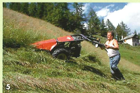
Klassische Mähmaschine mit Messerbalken: der Motormäher. Er wird auch im Berggebiet zunehmend durch die effizienteren Zweiachs-mäher abgelöst, v.a. durch Kreismäher.
