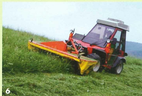
Klassische Mähmaschine mit Messerbalken: der Motormäher. Er wird auch im Berggebiet zunehmend durch die effizienteren Zweiachs-mäher abgelöst, v.a. durch Kreismäher.
